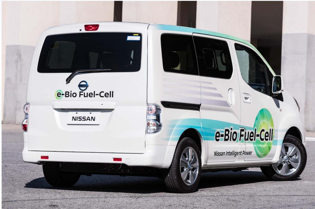
**Tiene una cruising range de 600km-plus con 30 litros etanol zero-emission, modelo Bio-Ethanol Fuel-Cell**
